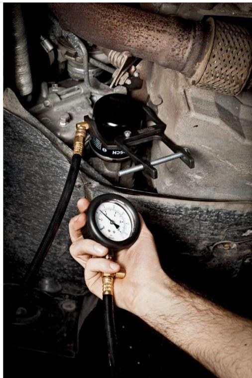
Sada na testovanie tlaku motorového oleja
