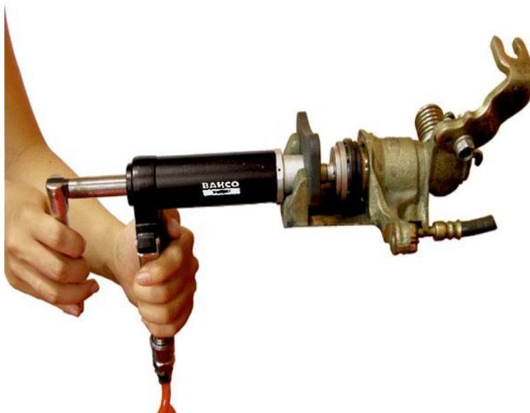
Vzduchová poštoľ na opravu vrzdového obloženia unášač 3/8" BBR320 slúži na demontáži brzdových valčekov
